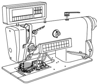
Einrichtung zum Beschneiden der oberen Stofflage
