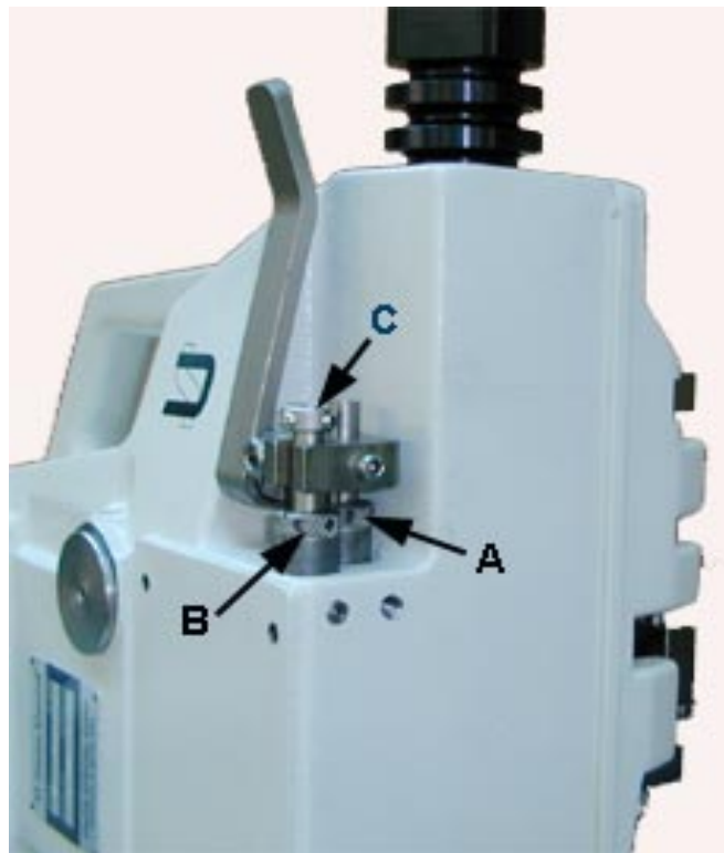
LOCATION OF LIMIT SCREWS AND LOCK NUTS FOR CHAINING SECTION AND PRESSER FOOT SETTING. POSITION DER ANSCHLAGSCHRAUBEN UND KONTERMUTTERN FÜR KETTEIL UND DRÜCKERFUSS.
