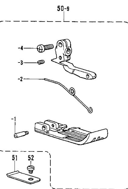
D. 押工関係 / Presser foot mechanism / Stoffdrückerfuß /
