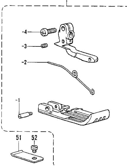
D. 押工関係/Presser foot mechanism/Stoffdrückerfuß/
