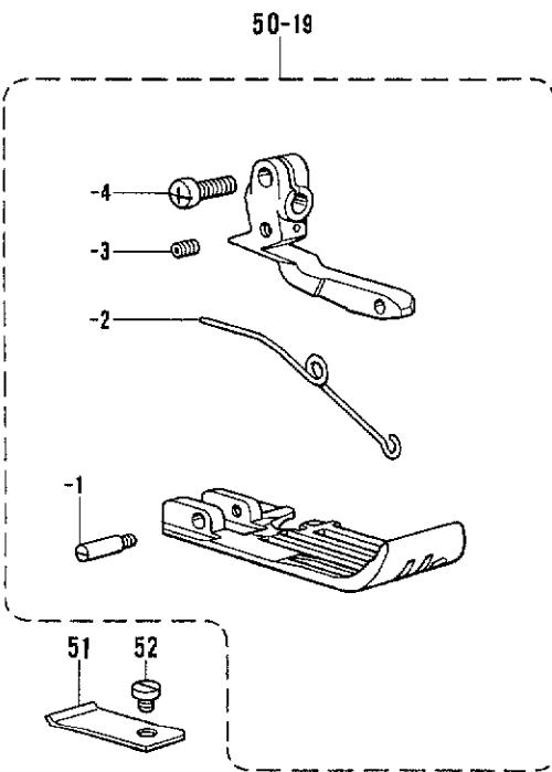
D. 押工関係/Presser foot mechanism/Stoffdrückerfuß/
