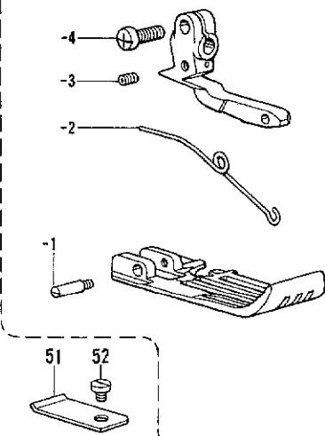
D. 押工関係/Presser foot mechanism/Stoffdrückerfuß/
