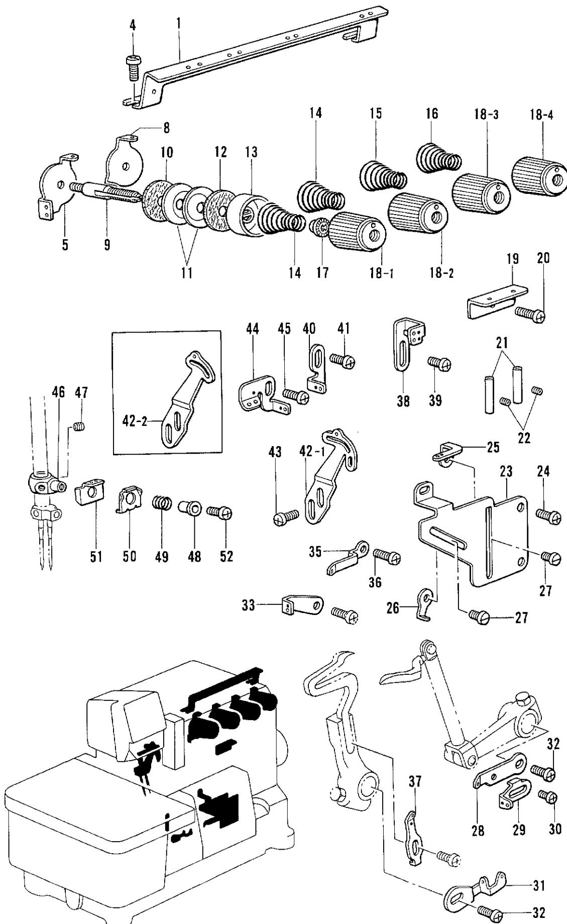
M. 糸調子関係 / Thread tension / Faderspannung /
