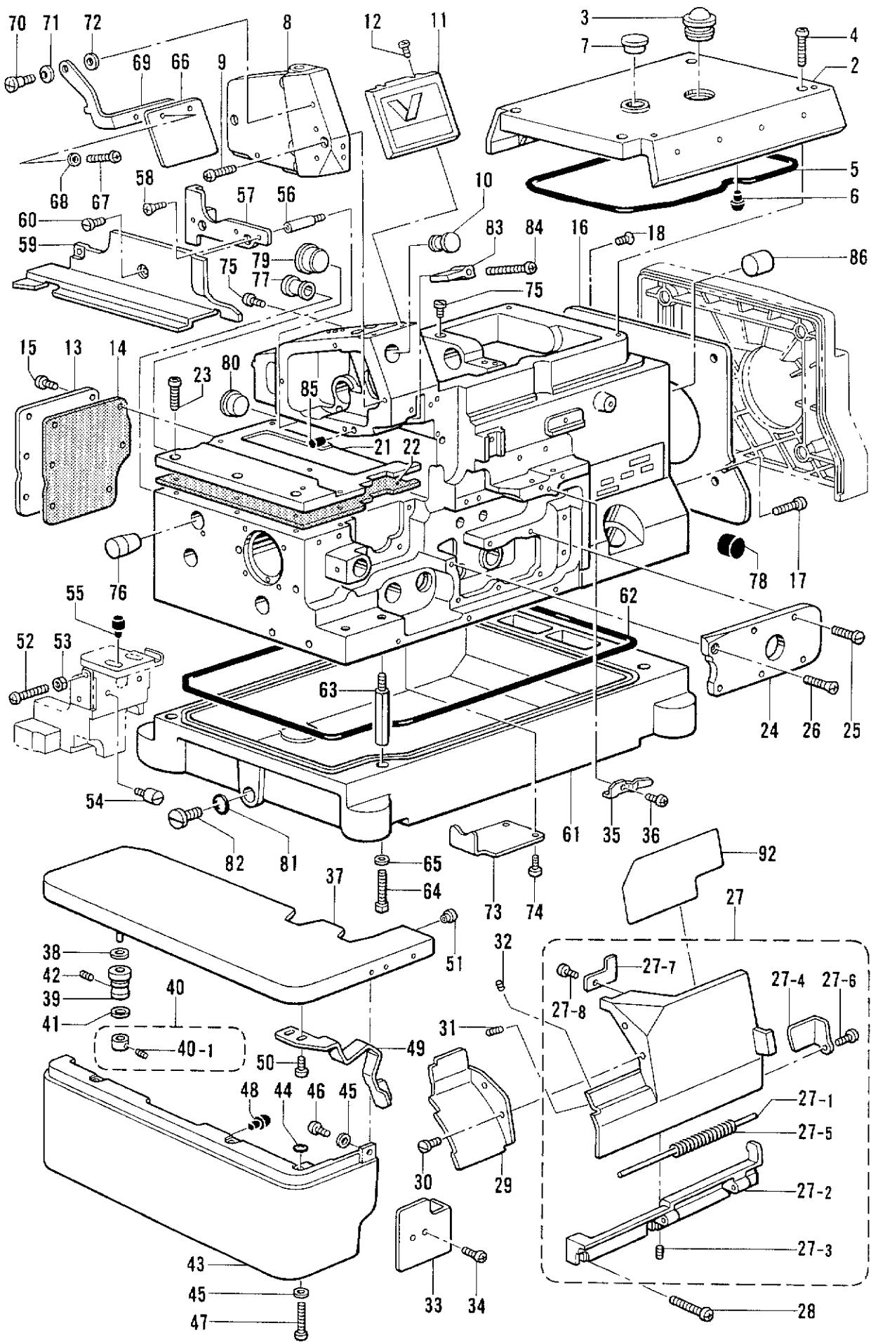
A. フレーム関係 /Machine body/Maschinengehäuse/
