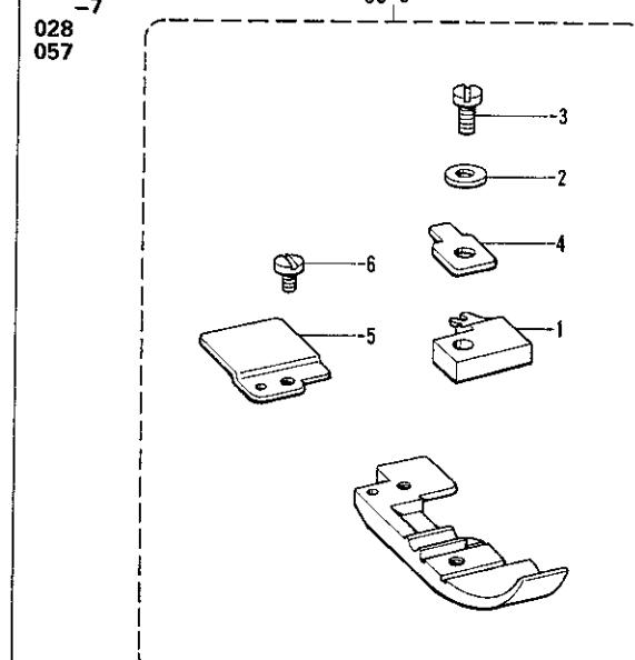
E. 押工関係/Presser foot mechanism/Stoffdrückerfuß/
