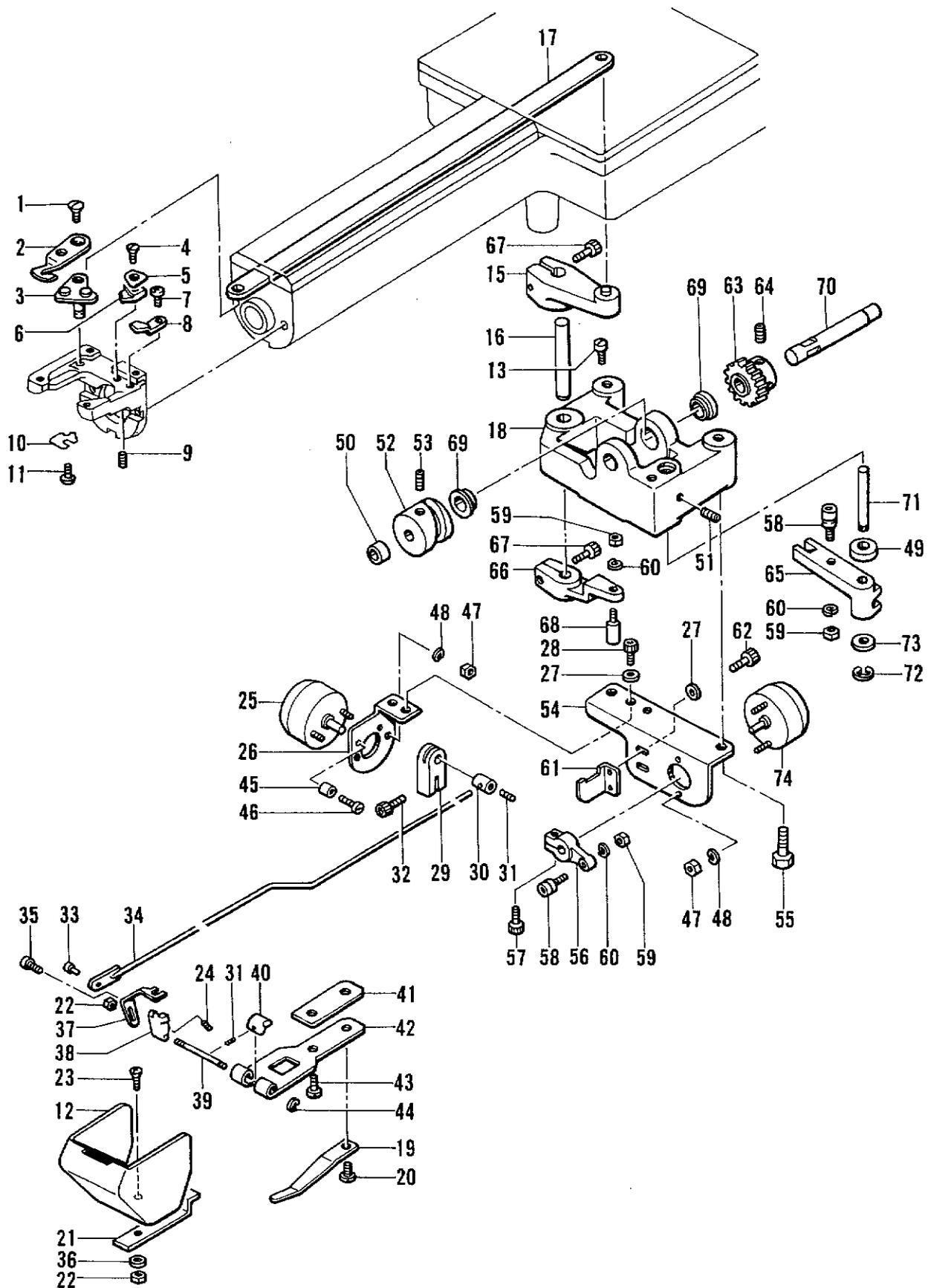
E. 糸切り関係/Thread trimmer mechanism/Fadenabschneidevorrichtung/
