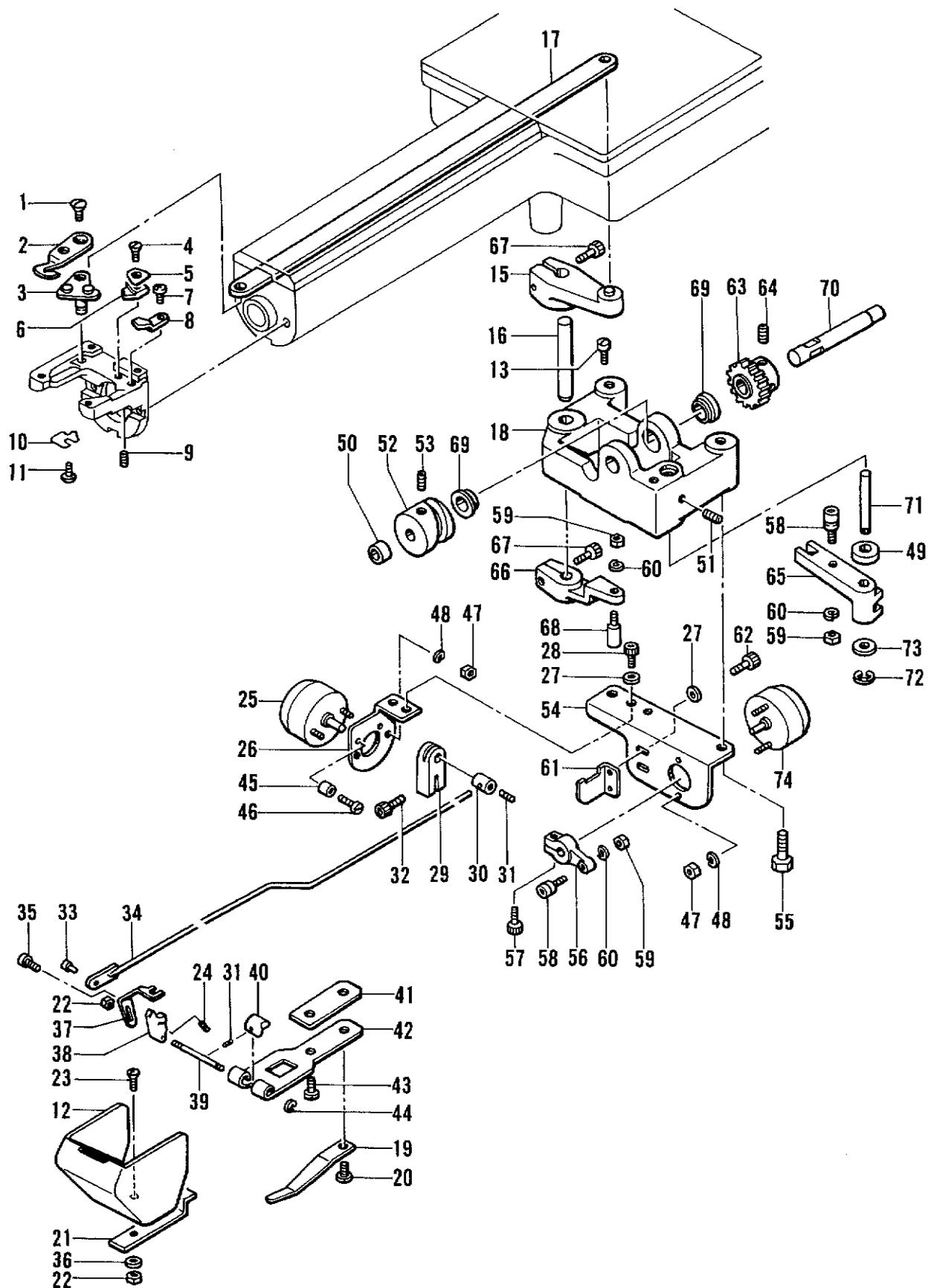
E. 糸切り関係/Thread trimmer mechanism/Fadenabschneidevorrichtung/
