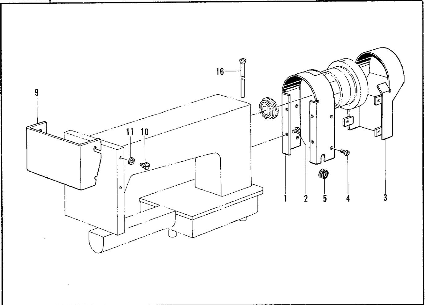
K. 押工関係 / Presser foot mechanism / Stoffdrückerfuß /
