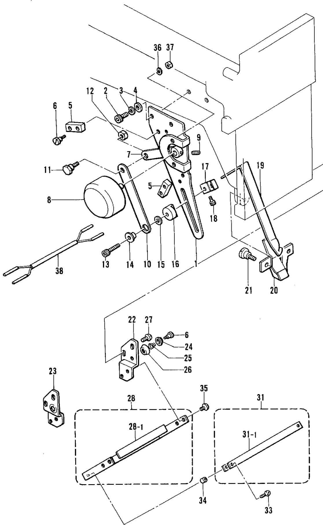
D. 糸払い関係/Thread wiper mechanism/Fadenwischvorrichtung/
