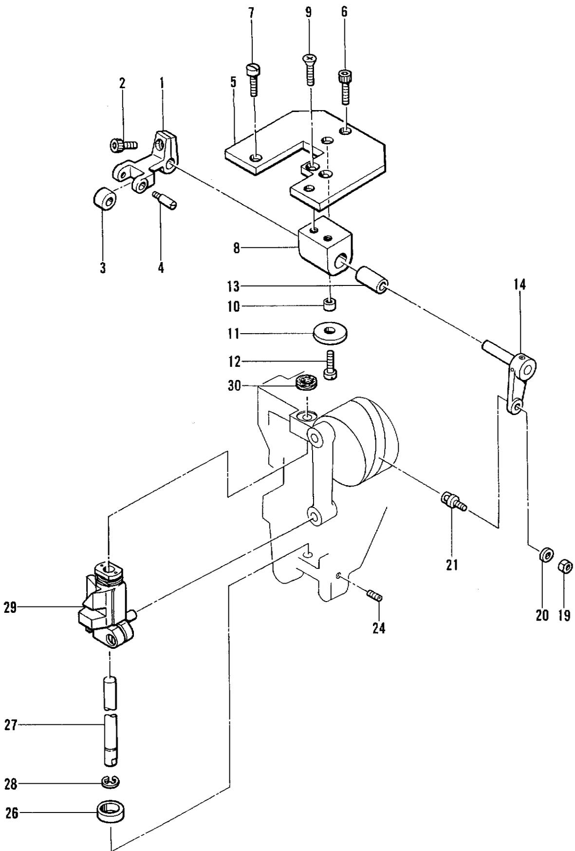
C. 針棒駆動関係/Needle bar and driving clutch mechanism/Nadelstange und antriebskupplung/Barre à aiguille et mécanisme d'entraînement/Barra de aguja y mecanismo de embrague de mando
