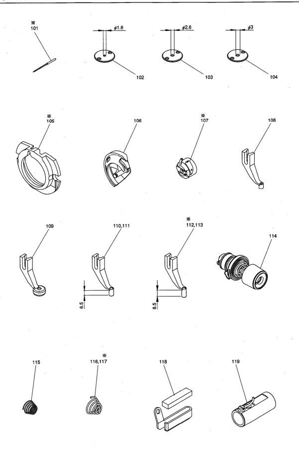
注:図中Fig.No.に※印を付した部品は電子ミシンPLK-E5050-LG、ならびにPLK-E10050-LGの機種に使用しています。 Note: The parts marked ※ on Fig Number are used for PLK-E5050-LG and PLK-E10050-LG.
